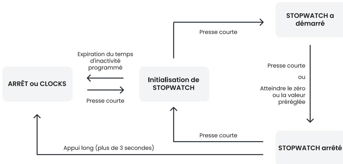
Le délai pour passer à l'affichage par défaut peut être réglé dans le menu **S E o P** de l'horloge digitale à l'article **h 7**.
