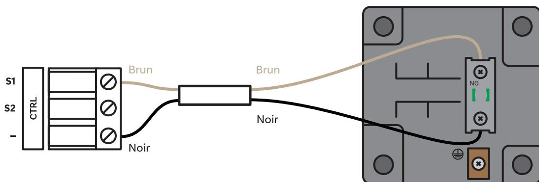
Bornier à vis (directement sur le circuit imprimé de l'horloge numérique) ; uniquement pour les horloges numériques de la série ECO-M-DC de génération 3 avec **option E**
