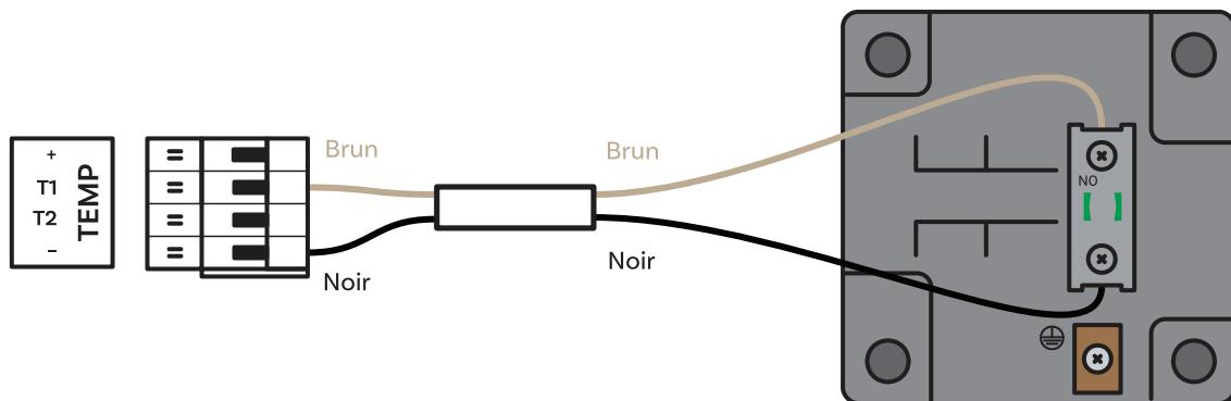
Bornier à vis (directement sur le circuit imprimé de l'horloge numérique)
