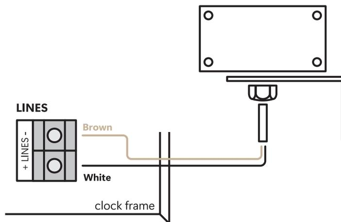
4. La longueur maximale du fil dépend de son diamètre (environ 100-300 m pour 0,25 mm<sup>2</sup>).
