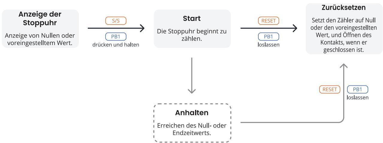
Zur einfachen Steuerung können Sie einen beliebigen externen Kontakt (z. B. ein von einem externen Gerät gesteuertes Relais) an den TEMP-Anschluss anschliessen.
