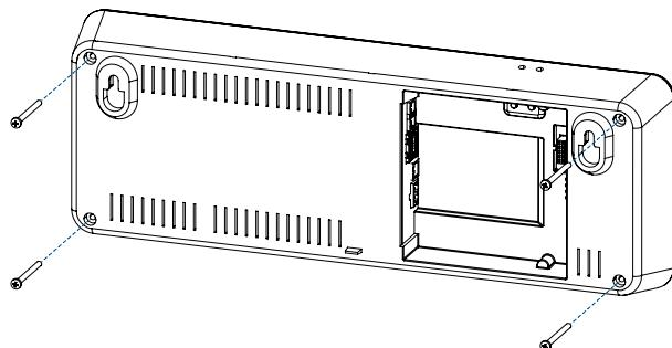
Schritt 1 – Entfernen Sie vier Schrauben auf der Rückseite des Rahmens.
