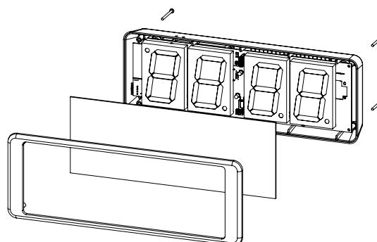
Schritt 2 – Entfernen Sie den vorderen Rahmen und das Plexiglas.
