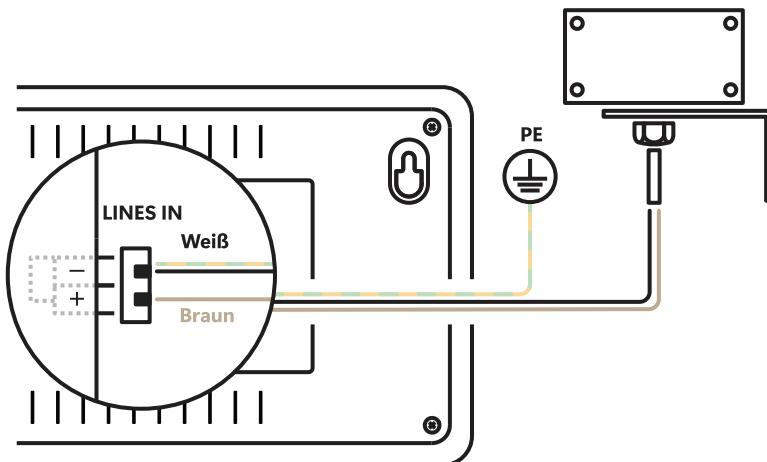
4. Die maximale Drahtlänge hängt von seinem Durchmesser ab (ca. 100–300 m bei 0,25 mm<sup>2</sup>).
