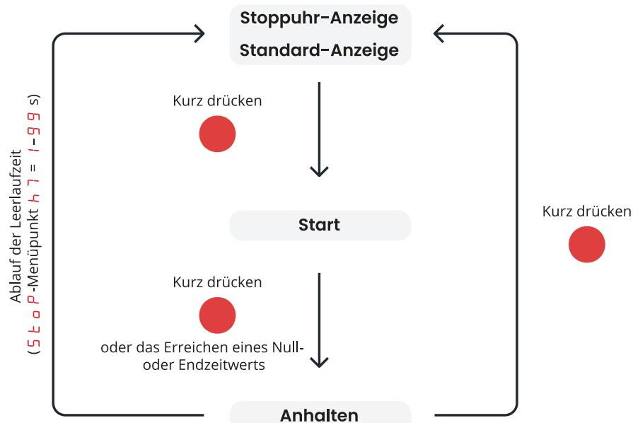
Die Standardanzeige kann unter dem **d 15P**-Menüpunkt **d 3** (Kapitel Zeitkonstanten für die automatische Datenumschaltung) eingestellt werden:
