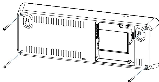
Paso 1 – Retire los cuatro tornillos de la parte trasera del marco.
