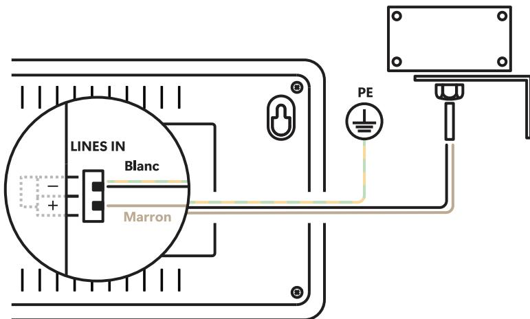
4. La longueur maximale du fil dépend de son diamètre (environ 100-300 m pour 0,25 mm<sup>2</sup>).
