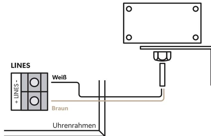
4. Die maximale Drahtlänge hängt von seinem Durchmesser ab (ca. 100–300 m bei  $0,25 \text{ mm}^2$ ).
