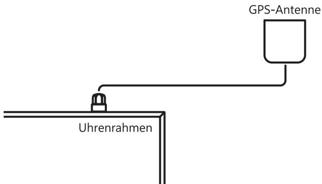
3. Wenn der GPS-Empfänger (GNSS 4500) an einer guten Position montiert ist, erfolgt die Synchronisation in ca. 10 bis 20 Minuten.
