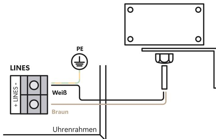
4. Die maximale Drahtlänge hängt von seinem Durchmesser ab (ca. 100–300 m bei 0,25 mm<sup>2</sup>).
